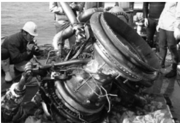
2000年1月に小笠原諸島の北西約380kmの海底(水深約3,000m)から引き上げられたH2ロケット8号機(1999年打上げ)の第1段エンジン(LE-7エンジン)
