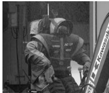
図6 バックホーを運転するHRP-1S
