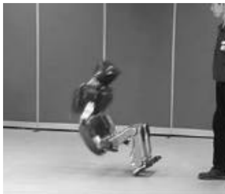
図2 転倒制御(HRP-2のプロトタイプ機による実験)
